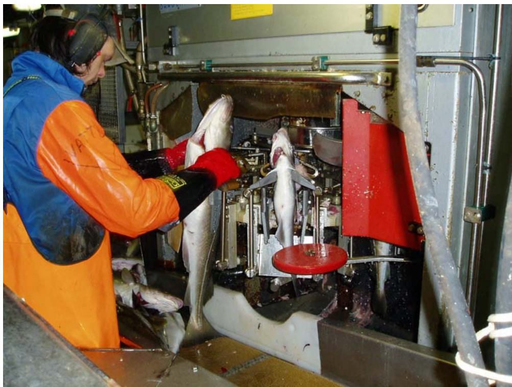
Bilde 15: Manuell mating av hodekapper, med nødstop
