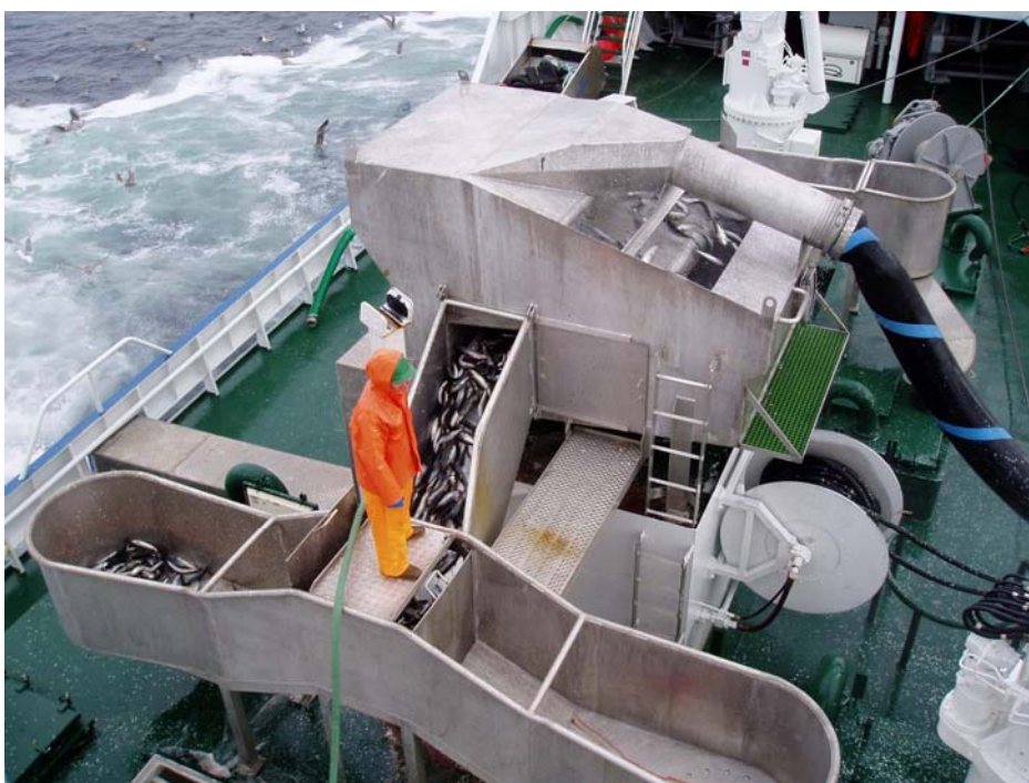
Bilde 12: Innpumping av sild og fordeling til ulike lastetanker
